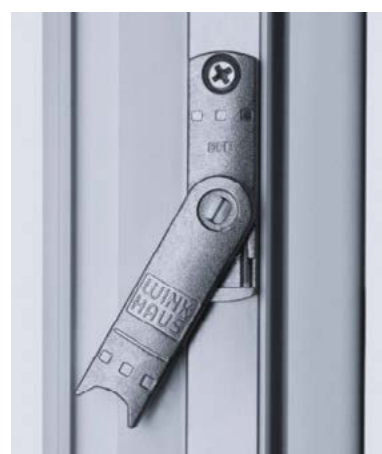
Tri-Funktionselement mit Fehlschalt-sicherung, Auflaufstütze und Balkontürschnäpper, der den Flügel ohne Verschließen im Rahmen hält. (Serienausstattung bei Balkontüren)
