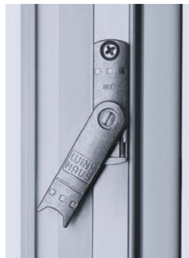
Duo-Funktionselement: Die Fehlschalt-sicherung verhindert eine Fehlbedienung des Fensters und beugt damit Schäden an Beschlag und Fenster vor. Zusätzlich sorgt eine integrierte Auflaufstütze für einen präzisen Einlauf des Flügels in den Rahmen (Ab sofort Serienausstattung)
